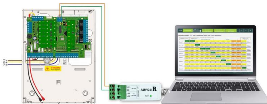
Рис. 141. Схема подключения прибора серии «A24» к ПЭВМ
